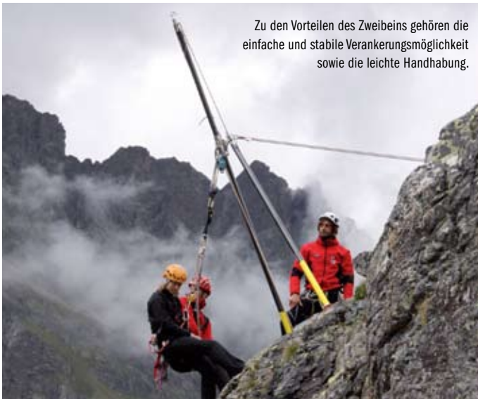
Wie bei allen angeführten Techniken kommt auch bei der Bergung nach unten ein Falldämpfer zum Einsatz. Außerdem ist es wie alle Systeme redundant.
