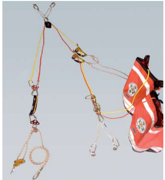
Wie bei allen angeführten Techniken kommt auch bei der Bergung nach unten ein Falldämpfer zum Einsatz. Außerdem ist es wie alle Systeme redundant.
