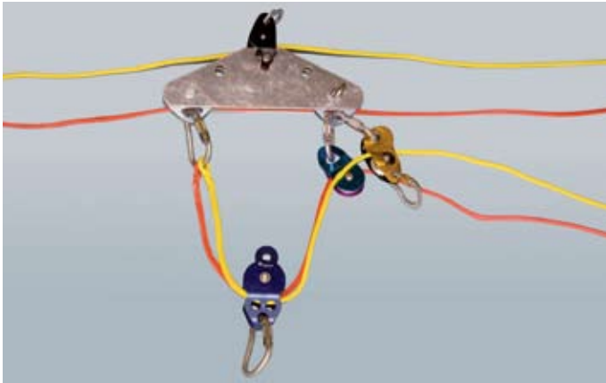
Für die Bergung aus Canyons werden Tragseile aus Dyneema (8 Millimeter rot/gelb) genutzt. Benötigt werden weiters – wie in der Abbildung zu sehen – noch Tandemrolle, Pro Traxion und Umlenkrolle.
