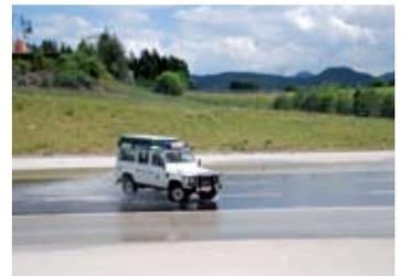
Der ÖBRD-Landrover schleudert nach einem simulierten Heckausbruch (hydraulische Platte).
