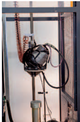
Links: Helme durchlaufen ein aufwändiges Testverfahren. Multifunktionshelme müssen für alle Teilbereiche die entsprechenden Normen erfüllen. Rechts: Eine Testanordnung, mit der der Aufprall auf einer Fläche simuliert wird.
