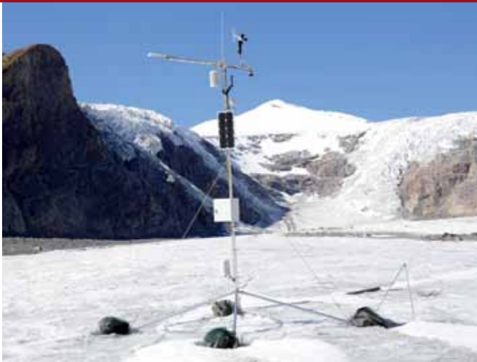
Die Wetterstation der ZAMG misst den Energiefluss, der auf die Gletscheroberfläche trifft und Energie für die Schmelze liefert. An der Plastikstange (Ablationspegel) rechts von der Wetterstation kann die Abschmelzung abgelesen werden. Von diesen bis zu zwölf Meter ins Eis gebohrten Stangen gibt es auf der Pasterze derzeit ca. 60.
