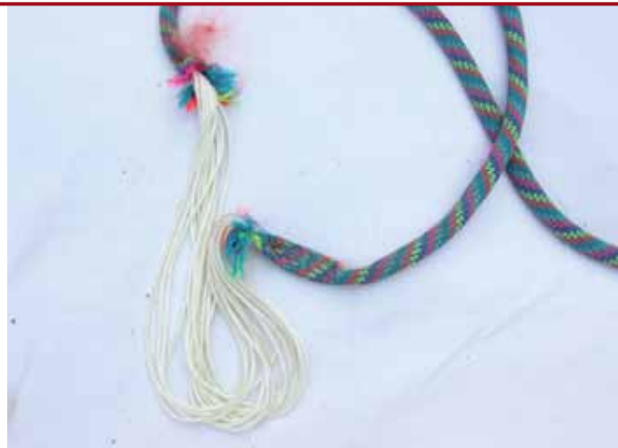
Die Falltests wurden mit „Sicherungsvarianten“ durchgeführt (z.B. aus Reepschnüren gebastelt), wie sie die Bergrettung bei Bergungen immer wieder sieht und die alles andere als sicher sind.
